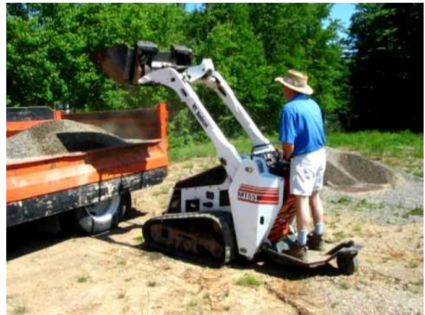
Ride-on mini compact track loader
