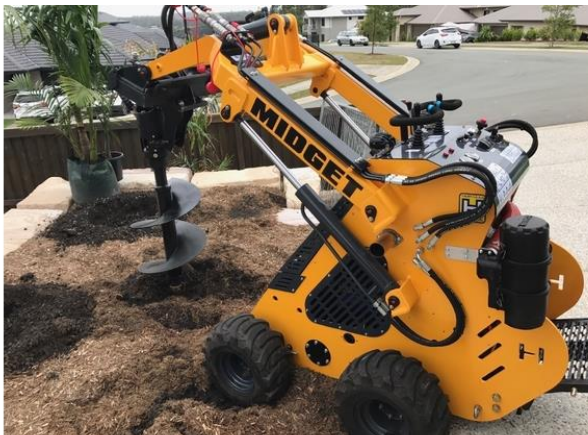
Walk-behind mini skid-steer loader.
