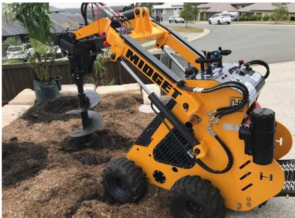
Walk-behind mini skid-steer loader.
