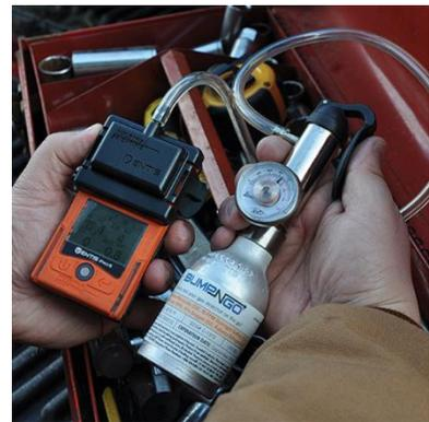
Prueba de respuesta utilizando una estación de acoplamiento.
